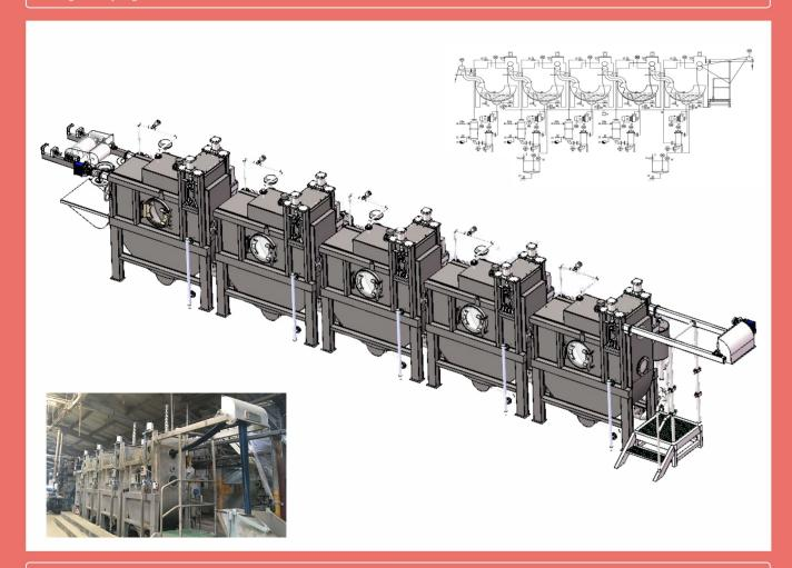
WRS绳状织物连续处理机用于织物的洗水,退浆,漂白。结合了溢流,喷射,压水等织物处理技术,与传统连续洗水技术比较可使处理织物在预缩率和手感方面得到明显改善,而且极大减少了水耗和能耗,其能耗数据如下:
